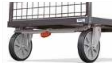
TOTALSTOP - Das fetra-Zentralbremsssystem Mit nur einem Fußtritt werden Raddrehung und Schwenkbewegung beider Lenkrollen blockiert. Das Bremspedal bleibt immer im Sichtfeld des Bedieners.
